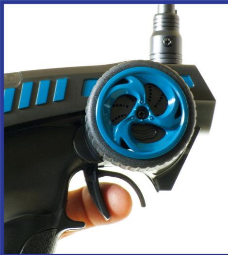
**Quand la gâchette de gaz est au neutre, le modèle doit être immobile. Si ce n'est pas le cas ajustez avec le trim de Gaz (N).**
