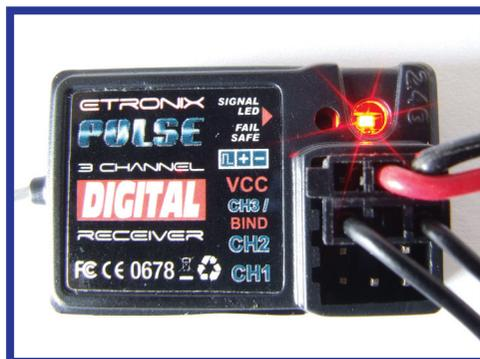
**Pour coupler votre récepteur et votre radio installez le cordon bind sur la voie Bind avant d'allumer votre récepteur. Allumez la radio en maintenant enfoncé le bouton bind, quand la LED du récepteur se stabilise la procédure est terminée. Eteignez l'ensemble et enlevez le cordon Bind, votre ensemble est prêt à fonctionner.**
