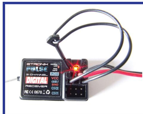
**Quand la procédure de Bind est terminée vous pouvez configurer la position de sécurité en enfonceant le bouton Failsafe avec le pointeur.**
